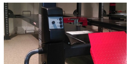
Styring og pumpe på bageste venstre søjle
